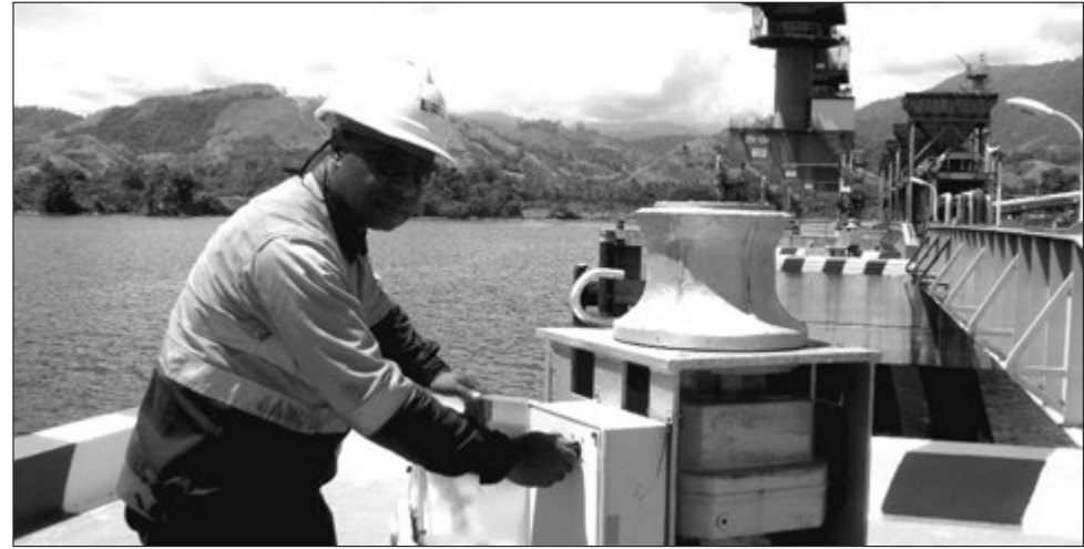
Saluk i redim liklik masin long pulim bikpela rop long holim sip long taim em sua.
